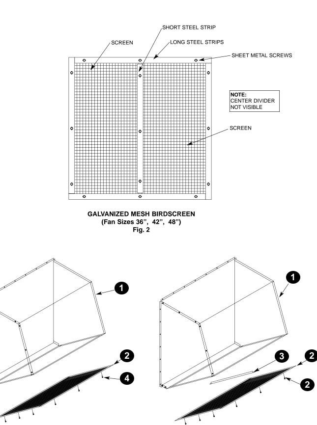
FLAT GUARD - OSHA STYLE (Fan Sizes 20", 24", 30") Fig. 3 FLAT GUARD - OSHA STYLE (Fan Sizes 36", 42", 48") Fig. 4
